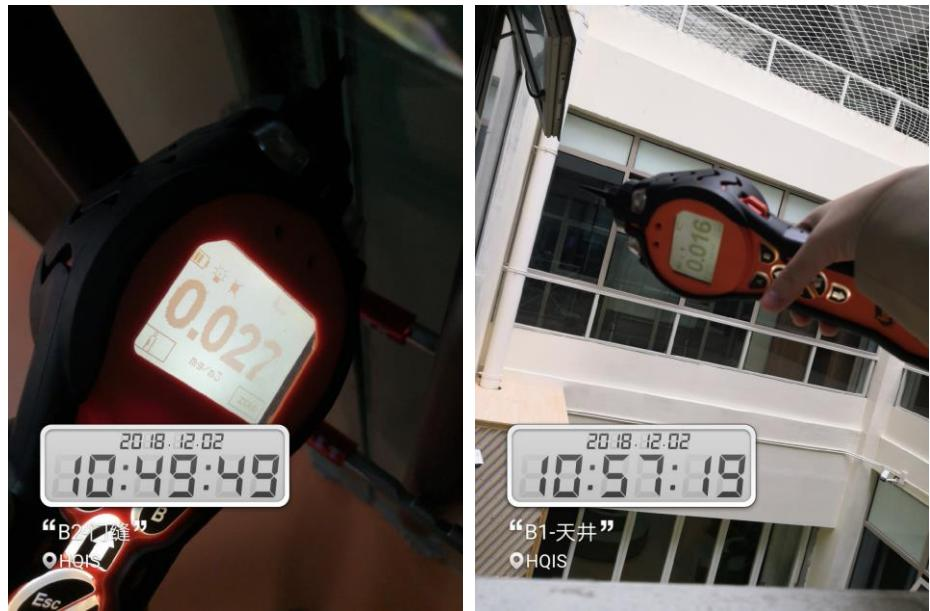
Figure 1-2. B2 层装修区域外门缝中和 B1 层天井处测得的 TVOC 读数接近
